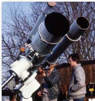
Hauptinstrument der AVSO für 24 Jahre: Das 30-cm-Spiegelteleskop von Wachter mit dem 15-cm-Refraktor.
