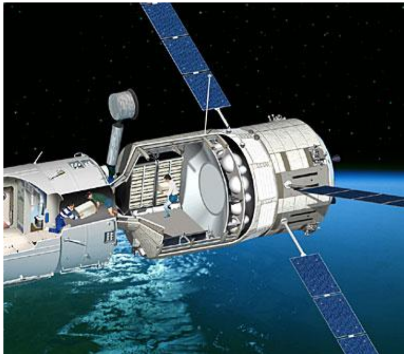
Schematischer Schnitt durch das ATV angedockt an die ISS Bild: ESA
